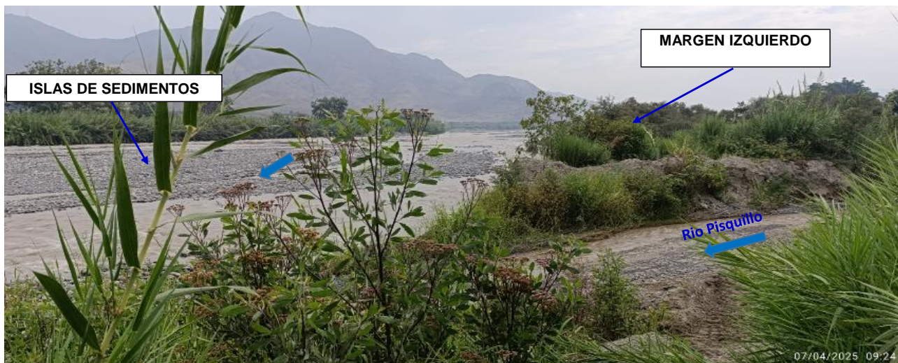
FIGURA N°03: RIO CHANCAY-HUARAL, CON EL CAUCE COLMATADO CON ISLAS DE SEDIMENTOS Y CON EL BORDE IZQUIERDO EROSIONADOS POR EL CAUDAL Y CONFLUENCIA CON RIO PISQUILLO.
